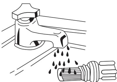
Para limpar o filtro: feche as registro de água; desaparafuse a válvula de segurança e o filtro. Remova o filtro e limpe-o. Siga as etapas no final para o início para remontar.
